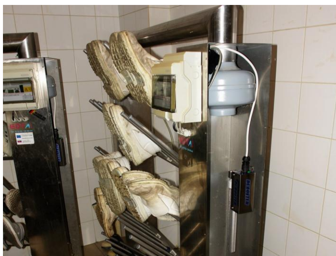
Inštalácia prístroja PT-1E OEM a PT-1E v sušičoch pracovnej
